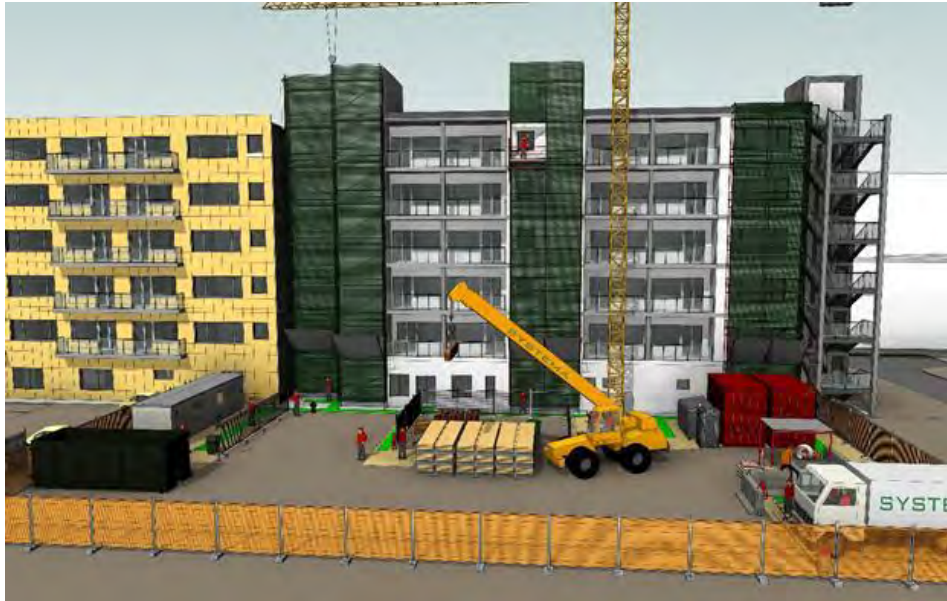
Figura 3.2 Es. di cantiere in BIM: individuazione degli spazi per la movimentazione dei materiali (infobuild.it)
